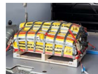
Kombinert lastesikringsnett og tverrbjelker
